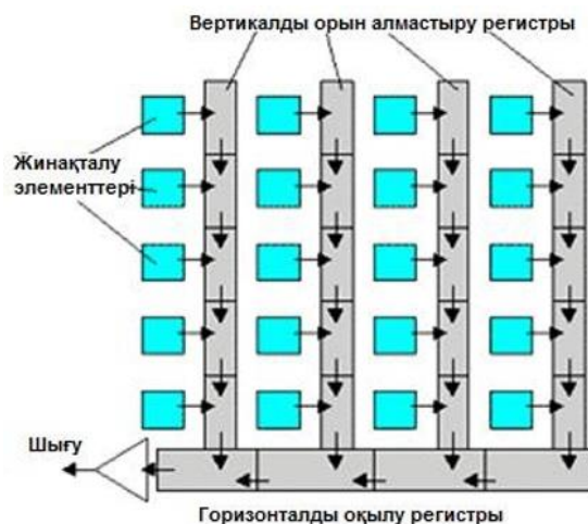
1.15 - сурет – ПЗС матрицаның құрылысы
